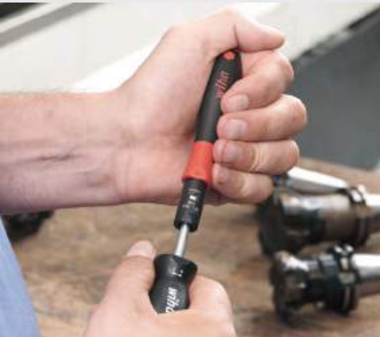
Dowolnie nastawiany moment dokręcania
