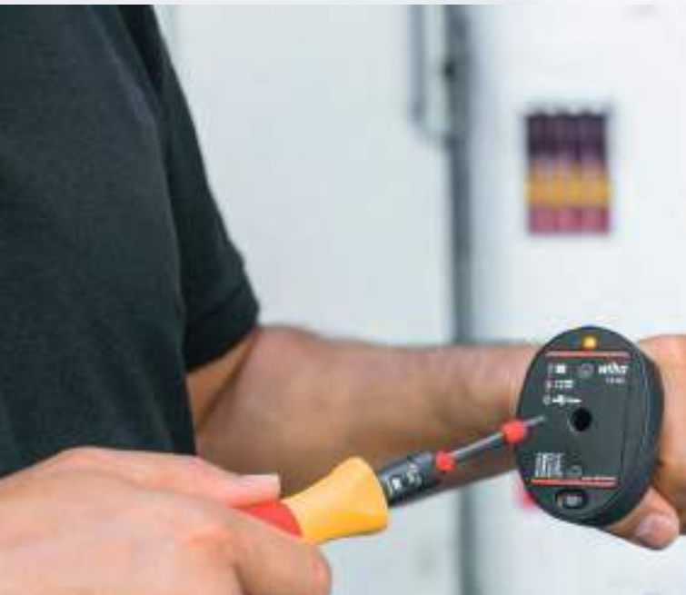
Przenośny tester narzędzi dynamometrycznych
